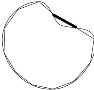
**Fig. 6.** Cuerdas usadas para calcular la concavidad [27].
